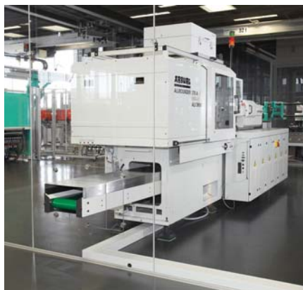
Arburg equips the Allrounder 370 A machine with a clean room module
